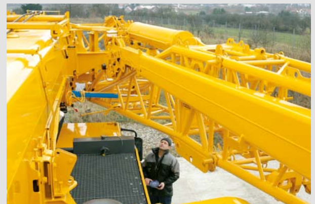
Ayuda hidráulica para el montaje del plumín lateral con el BTT
